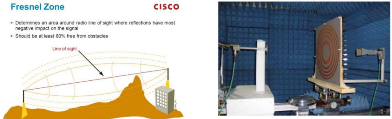
Figure 25: Aplicações das zonas de Fresnel: esquerda, bloqueio intencional e direita, lente de Fresnel. Fonte CISCO (esq.) e Microwave and Optical Technology Letters DOI 10.1002/mop (direita)
