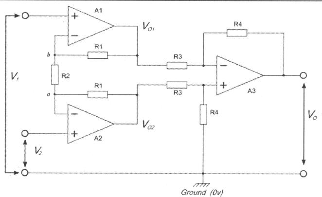
2. (2p) Calcule a saída  $V_o$  do circuito para duas excitações  $V_1$  e  $I_1$ .
