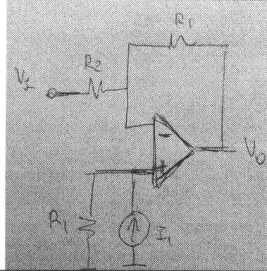
3. (3p) Para o amplificador ao lado, suponha  $I_E=10\text{mA}$ ,  $\text{Ad}=1000$ ,  $\text{CMRR}=100 \text{ dB}$ .
