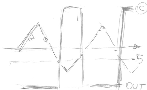
(b) gerador PWM, potenciómetro controla o duty cycle
