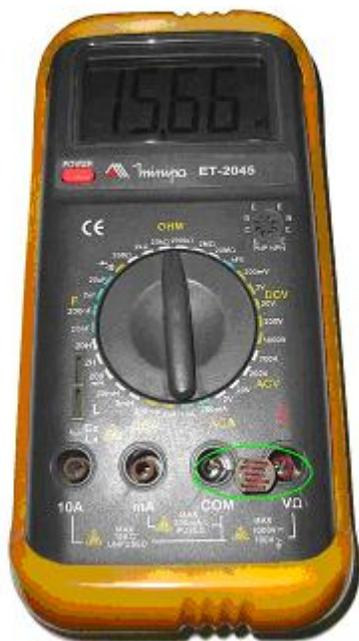
**Figura 3.** LDR acoplado em multímetro.
