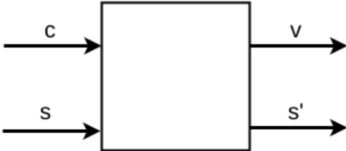
Figura 2: Transformador de estado
