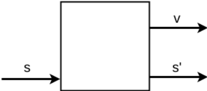
Figura 1: Transformador de estado
