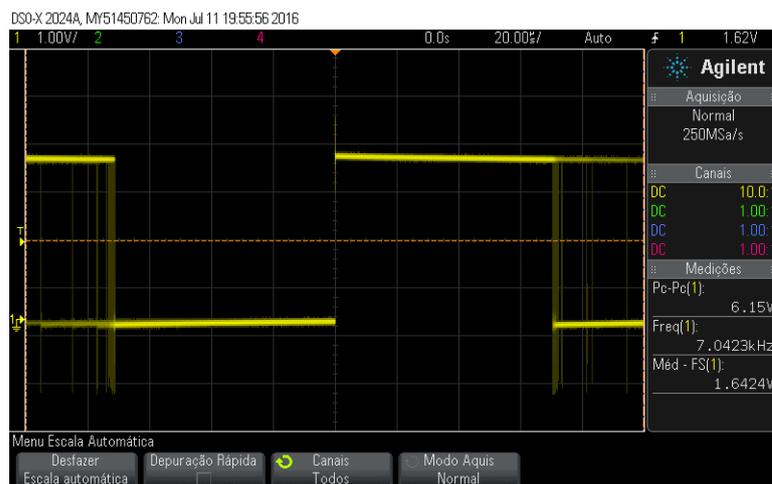
Figura 28 – Frequência de ativação/desativação do *clock* utilizando pinos GPIO.
