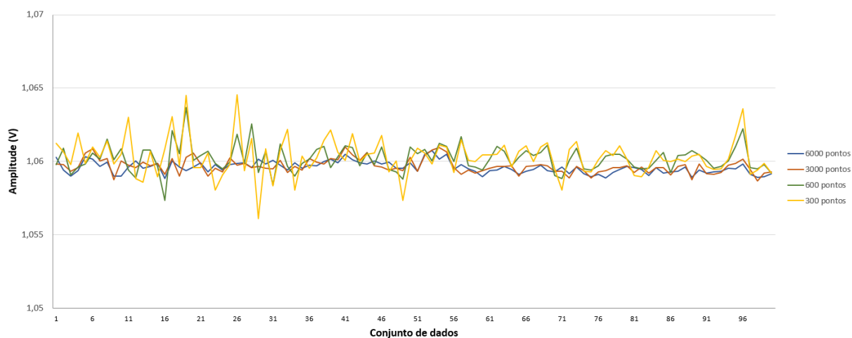
Figura 40: Variação da amplitude calculada em função do conjunto de dados para frequência aproximada de 2 kHz, onde diferentes curvas apresentam o valor calculado a partir de diferentes quantidades de dados de cada conjunto de medidas
