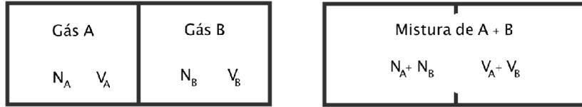
Figura 3.2: Mistura de dos gases ideais. A esquerda o estado inicial, antes da mistura. A direita o estado final, após a mistura.
