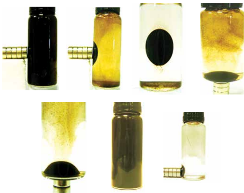
Figura 13. Ferrofluido formado por partículas magnéticas diluídas em água. O gradiente de campo magnético gerado pela aproximação do ímã faz com que as nano/micropartículas magnéticas se concentrem na região próxima ao polo magnético do ímã, separando-as do meio. Imagens obtidas no laboratório de Matéria Condensada II, 508-3-UFABC.
