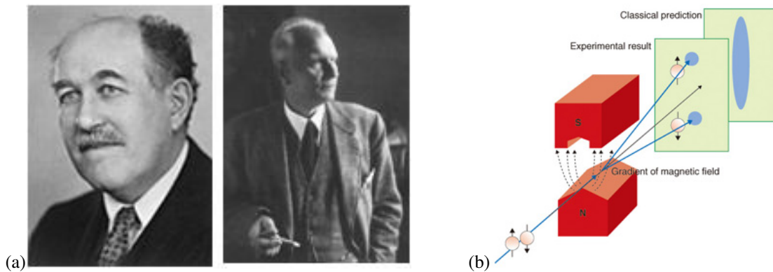
Figura 3: (a) Stern e Gerlach; (b) o experimento em que foi observado a quantização do spin do elétron.
