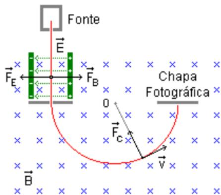
Figura: Espectrômetro de massa.
