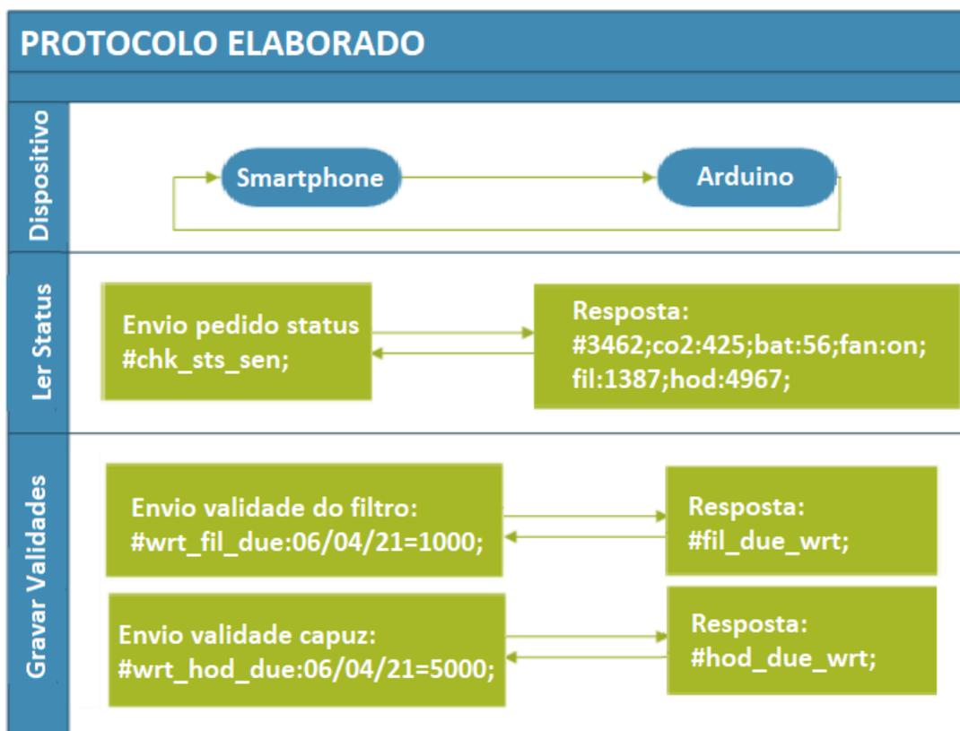
Figura 9: Protocolo elaborado para intercâmbio de dados entre a eletrônica embarcada e o aplicativo do *smartphone* usando expressões regulares. Fonte: autoria própria.
