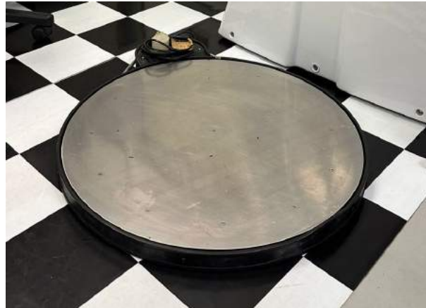
Figura 3.7 – Plataforma giratória utilizada na rotação do manequim
