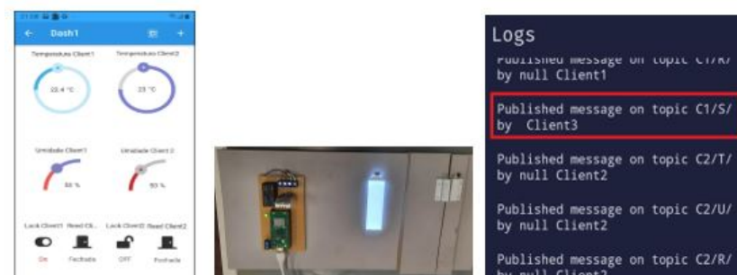
Figura 15 – Acionamento do ícone no dashboard responsável por acionar o relé do prototipo RASPBERRY e a resposta com a energização do led. Fonte: Próprio autor
