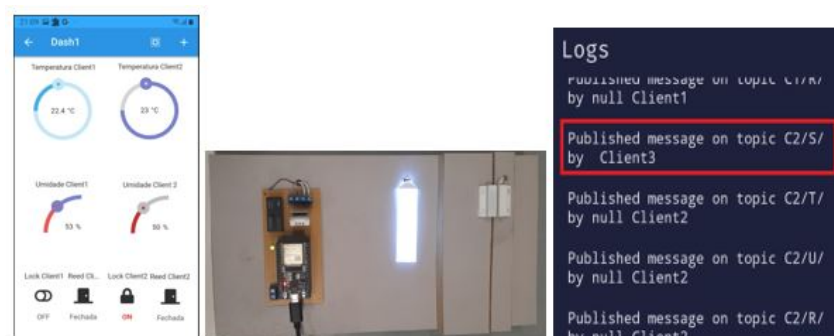
Figura 16 – Acionamento do ícone no dashboard responsável por acionar o relé do prototipo ESP32 e a resposta com a energização do led. Fonte: Próprio autor
