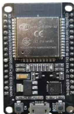
Figura 3 - Exemplo do microcontrolador ESP32
