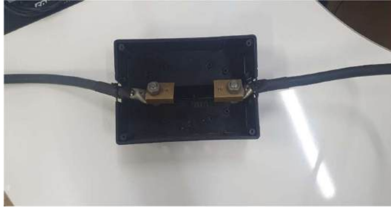
Figura 7 - Resistor de shunt em invólucro de proteção.
