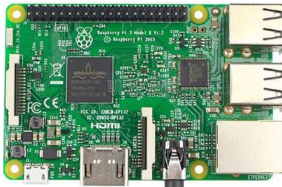
Figura 4 - Exemplo do microcomputador Easberry Pi 3B+
