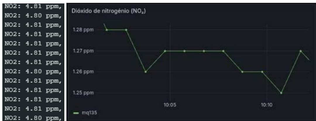
Figura 18 : Medição NO2. Fonte: IDE Arduino
