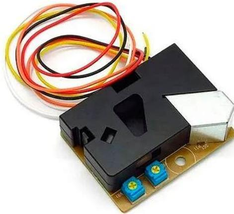
Figura 8 : Sensor DSM501A. Fonte: Ebay
