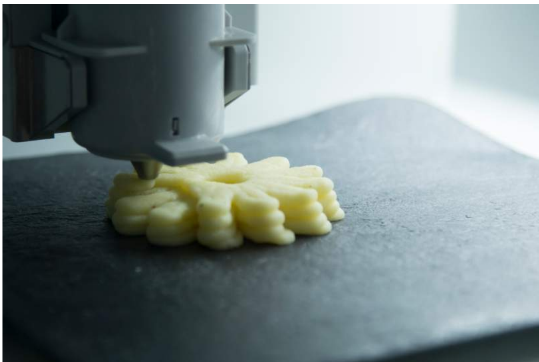
Figura 12 – Exemplo de Impressora 3D do tipo seringa extrusora. (Fonte: Foto de foto_diego via licença Creative Commons < https://www.shutterstock.com/pt/image-photo/3d-printed-food-mashed-potatoes-1643884318 >)
