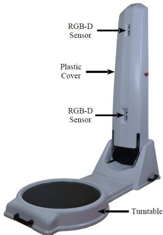
Figura 15 – Scanner 3D multifuncional desenvolvido na Universidade Federal do ABC. (Fonte: (GAZZIRO et al. , 2019)).
