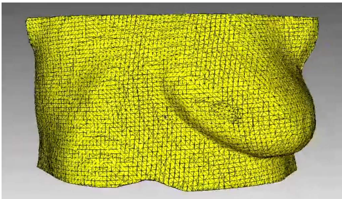
Figura 26 – Malha do tórax isolada e tratada pelo software na região próxima às mamas.
