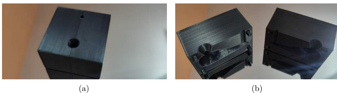
Figura 31 – Novo molde gerado com o auxílio do software Blender a) Molde com as duas faces encaixadas b) Molde aberto, mostrando o seu interior.
