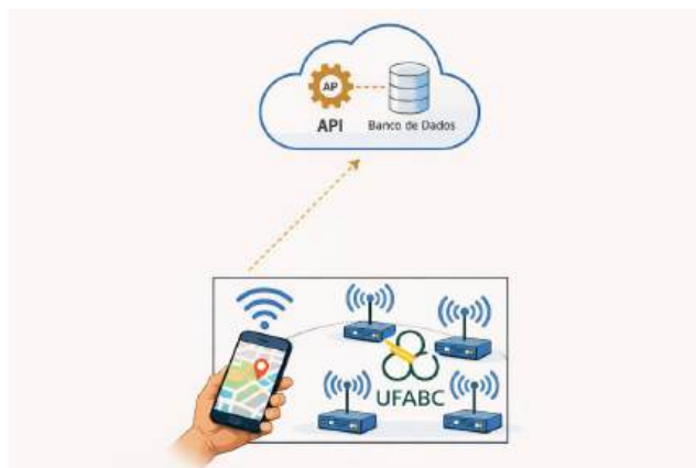
Figura 1: Representação esquemática do sistema de localização indoor
