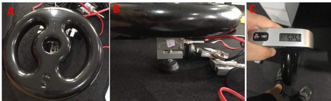
Figura 13 – A imagem A mostra o peso de academia, a imagem B mostra a pesagem pela célula de carga, e a imagem C mostra o peso real do objeto, 5,25Kg . Fonte: autoria própria
