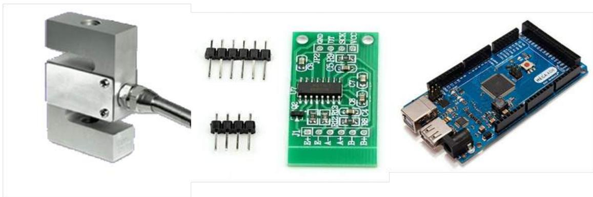
Figura 8 – Da esquerda para à direita: Célula de carga; Módulo HX711; Arduino. Fonte: (MK, Acesso: 25/01/2020) (FLOP, Acesso: 05/02/2020) (ELETROGATE, Acesso: 05/02/2020)
