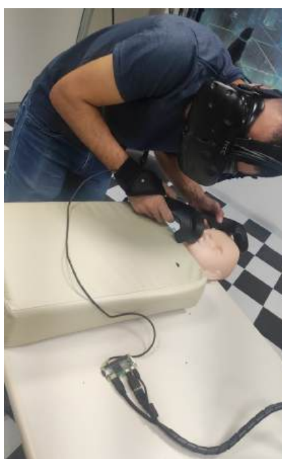
Figura 4 – Coleta de dados com co-registro na Sessão B, em 2 etapas, com destaque para o sistema embarcado construído com Raspberry Pi Zero 2W na parte inferior da foto.
