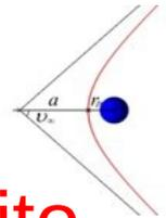
e **parabólica** no caso limite quando  $E = 0 \Rightarrow v = v_{\text{esc}}$   $\Rightarrow$  o corpo também vai pro **infinito**.
