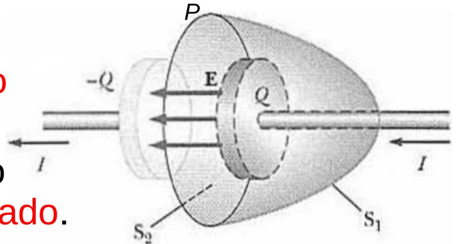
A variação do fluxo do campo elétrico através de  $S_2$  é proporcional ao aumento de carga na placa direita do capacitor que é proporcional à corrente  $I$ .
