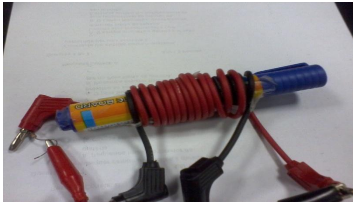
Figura 3. Montagem experimental utilizando uma caneta de quadro branco como suporte dos solenoides. O solenoide montado com cabo preto é o gerador de campo magnético. A variação do fluxo de campo magnético induz uma força eletromotriz no solenoide vermelho.
