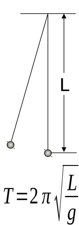
$$g = \frac{4\pi^2 L}{T^2} \begin{cases} \text{Período: } T = 1,72 \text{ s} \\ \text{Comprimento do fio: } L = 73,45 \text{ cm} \end{cases}$$
