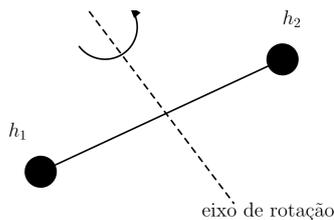
8. Uma barra delgada e uniforme de massa  $M$  e comprimento  $L$  possui uma bola muito pequena de massa  $m$  grudada em cada extremidade. Ela é sustentada horizontalmente por um eixo fino, horizontal e com atrito desprezível, que passa pelo seu centro e é perpendicular à barra. Subitamente, a bola do lado direito se descola e cai, mas a outra permanece grudada na barra. O momento de inércia da barra girando no eixo de rotação do problema é  $I = ML^2/12$ .
