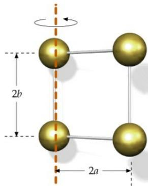
7. Imagine uma estação espacial orbital hipotética, esquematizada na figura, que procura simular a aceleração da gravidade dentro dos habitáculos  $h_1$  e  $h_2$  impondo uma aceleração centrípeta
