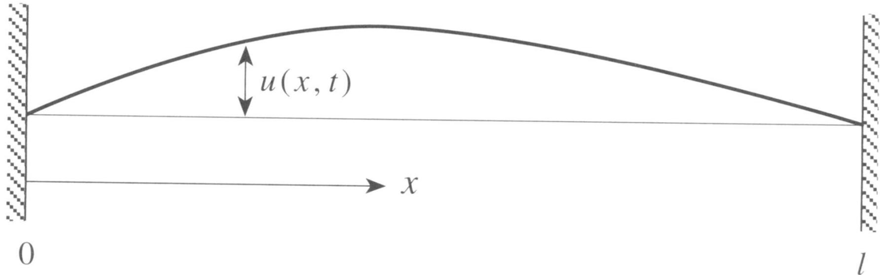
Para a corda vibrante, presa em  $x = 0$  e  $x = l$ , a grandeza que se propaga é o **deslocamento** transversal  $u(x, t)$ .
