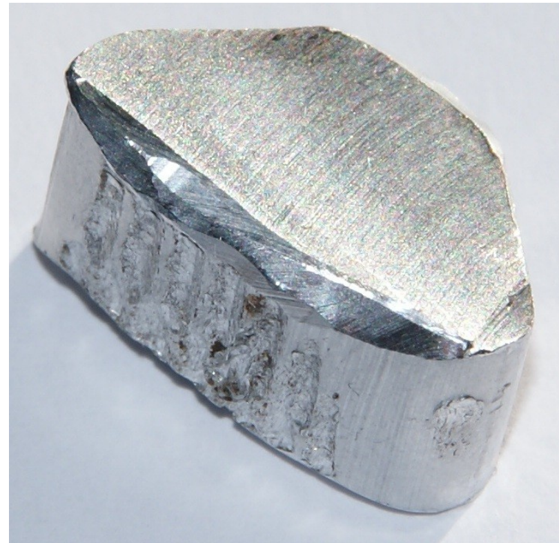
Alumínio, com estrutura ccp/fcc
