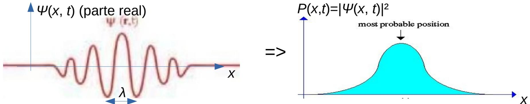
Neste caso, os máximos e mínimos da parte real da função de onda coincidem com os pontos zero da parte imaginária, e vice-versa. Como a distribuição de probabilidade é a soma dos quadrados das partes real e imaginária, os mínimos e máximos não aparecem na distribuição de probabilidade.
