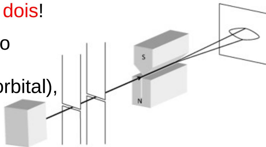
Figura 1 - Representação esquemática do experimento de Stern-Gerlach.
