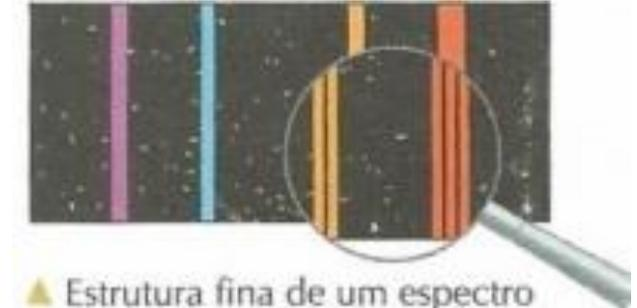
▲ Estrutura fina de um espectro atômico. (Esquema fora de proporção em cores fantasiosas.)
